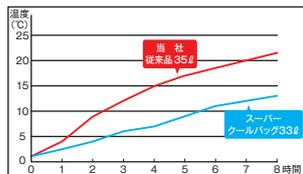
40℃に設定した部屋に1℃の冷水が入った500mlのペットボトルを20本入れたクーラーバッグの中央の8時間後のボトルの水温度上昇の比較。
